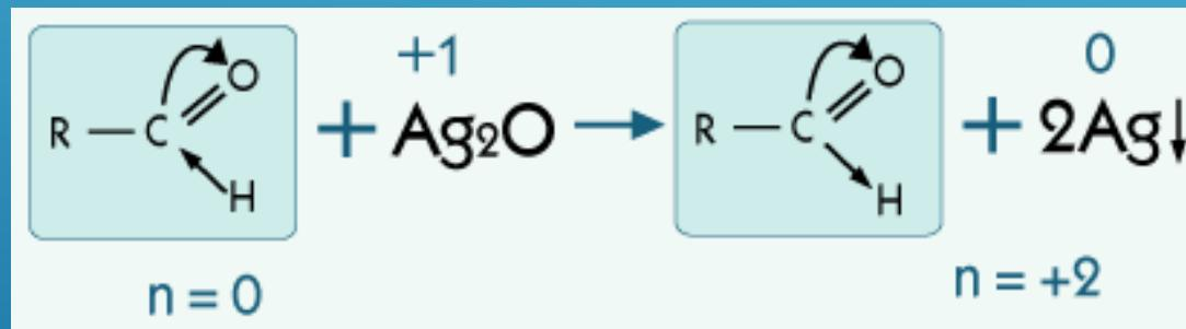
На стенках сосуда осаждается металлическое серебро, образуя на поверхности слой металла, похожий на зеркало. Поэтому качественная реакция на альдегиды называется “реакцией серебряного зеркала”.
